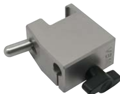
Schnellverschluss-Schienenklaue 25x10mm für Normschiene REF - mit 11mm durchgehender Bohrung und Feststellschraube 79-040-00 - mit 8mm durchgehender Bohrung für Rüschi „Ulmer Fixator“ 79-041-00
